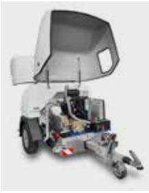
Couvercle avant et arrière et réservoir d'eau en fibre de verre
