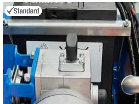
Levier neutre pour déverrouiller le moulinet
