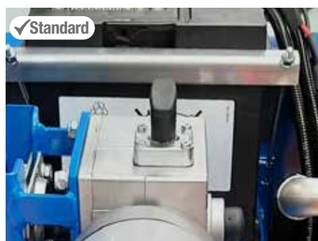
Levier neutre pour déverrouiller le moulinet Neutralhebel zum Entriegeln der Rolle
