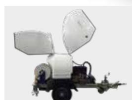
Capots avant et arrière et réservoir d'eau en fibre de verre
