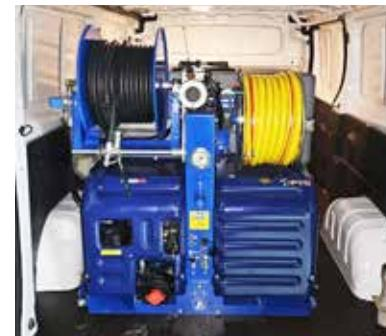
Version avec enrouleur de tuyau électrique
