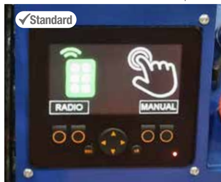
Écran à couleur pour la gestion de la machine PLC-Farbbildschirm zur Verwaltung der Maschine
