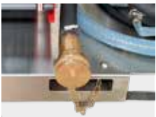
Kit de enchimento do depósito de ligação UNI 45 UNI 45 water hydrant connection
